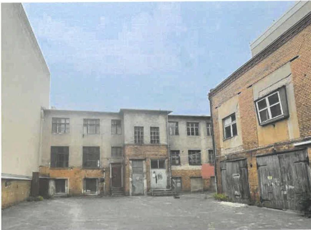
Abbildung 6: Rückwärtige Ansicht des Vorderhauses mit Blickrichtung Südwesten. Rechts im Bild: Werkstattgebäude mit beschädigter Klinkerfassade oberhalb der Fenster. Standort: Innenhof.
