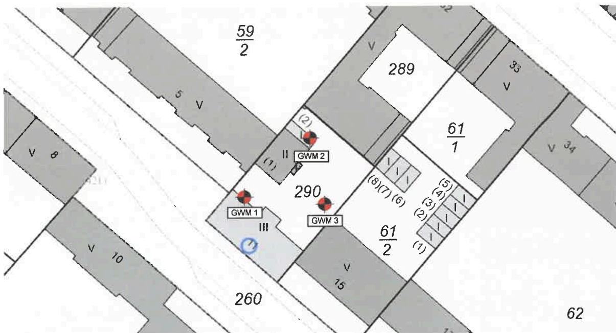
Abbildung 5 - Drei errichtete Grundwassermessstellen (GWM 1 – GWM 3)
